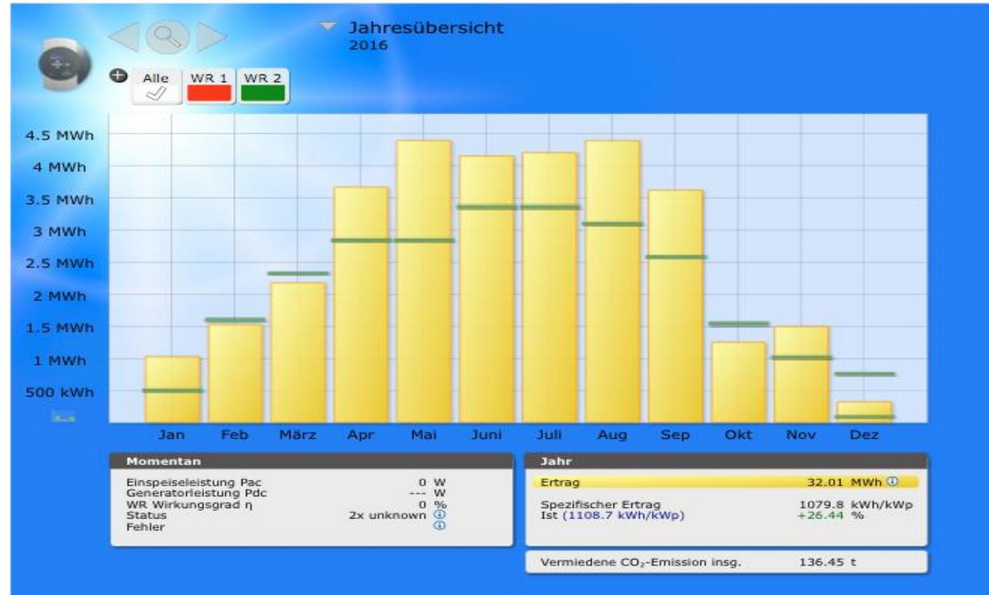
Objekt SW12 – Jahresstromproduktion 2016: 32,01 MWh / 1079,8 kWh/kWp
